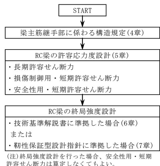
解図 3.1 本工法による RC 梁の設計フロー
